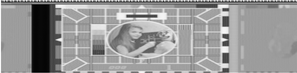
Abbildung 2: Das decodierte Roh-Bild. Die Bildbreite von 5292 Pixeln entspricht exakt der Dauer einer Robot36-Bildzeile.
